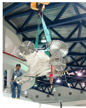
การติดตั้ง Bending magnet chamber ในวงกักเก็บอิเล็กตรอน
