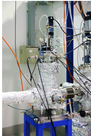
การติดตั้งระบบวัดตำแหน่งลำแสงซินโครตรอนบริเวณระบบลำเลียงแสงที่ 6
