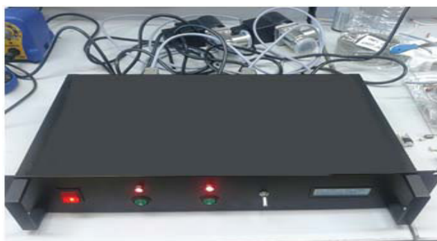
ชุดระบบควบคุมเกทวาล์ว ขณะทำการทดสอบ
