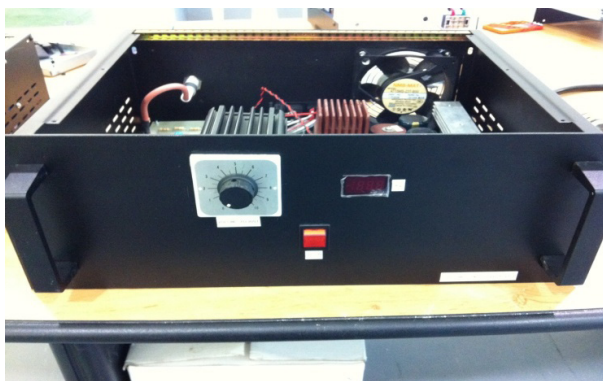
แหล่งจ่ายไฟฟ้าของไอออนัม ขณะทำการทดสอบ
